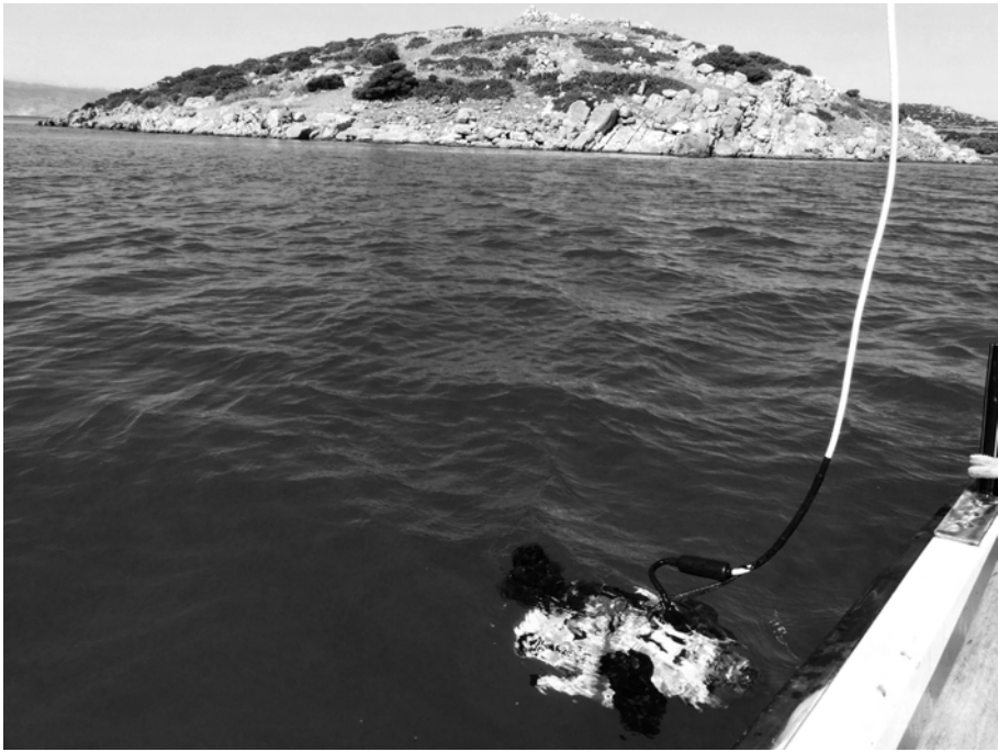
Είχ. 3. Τὸ ὑποβρύχιο τηλεκατευθυνόμενο ὄχημα Mini-ROV Guardian Subsea Tech (ἔδῶ στὸν κόλπο τοῦ Βαθέος) εἶναι ἐξοπλισμένο μὲ ὑποβρύχιο σύστημα προσδιορισμοῦ θέσης μεγάλης ἀκρίβειας (USBL).
