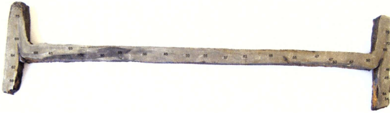
Είκ. 5. Διακρίνεται στο άριστερό τμήμα του συνδέσμου νησίδα σκοτεινόχρωμου σκληρού χάλυβα.
