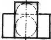
C 2 : Περιορισμός τοῦ κατά μήκος ἄξονα μέ τή χρήση ἑνός ἡμιτρούλλιου.
