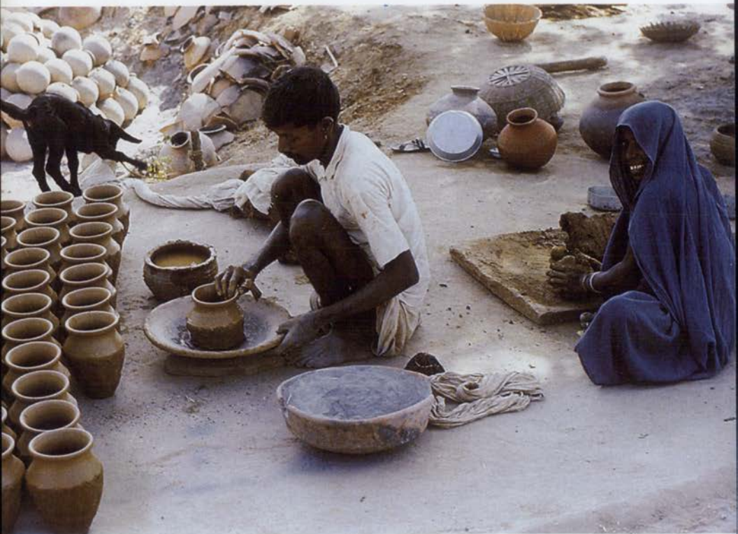
11. Εργαστήριο χειροποίητης κεραμικής έξω από το Kazuraho στην Ίνδία. Δεξιά η τελική μάλαξη του πηλού. Άριστερά η κατασκευή του αγγείου.
